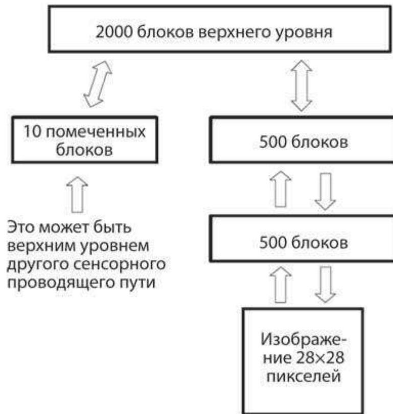
Рис. 7.6. Многослойная машина Больцмана для распознавания и формирования рукописных цифр. Размер изображения – 28 \times 28 = 784 пикселей, которые могут быть белыми и черными. Цель – определить цифру на основе 10 выходных единиц (0–9)
